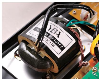
采用一只 R 型变压器线性电源供电，采用厚铝板做变压器底座，提供更好的强化避震效果
