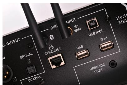
齐备的数字输入界面，除了 B 型 USB 连接电脑外，还提供两个 A 型 USB 接口，一个用与连接 U 盘或移动硬盘，另一个连接 iPod，还包括一个 S/PDIF 同轴
