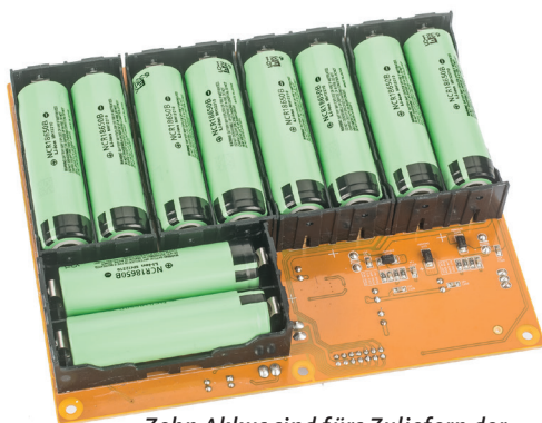
Zehn Akkus sind fürs Zuliefern der Betriebsspannungen zuständig
