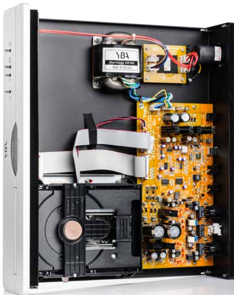
Pród napędu komputerowego, odtwarzacz składa się z płytki audio zawierającej cały tor cyfrowy i analogowy oraz transformatora R-Core.
