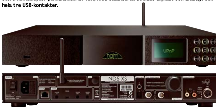
Notera omkopplaren för DIN eller RCA till höger och högkvalitativa digitala BNC-kontakter.
